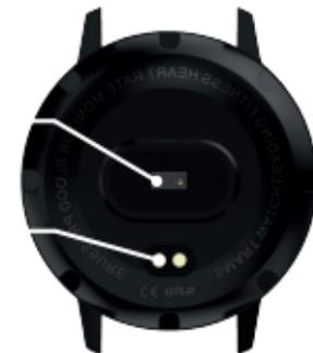
Перед первым включением зарядите устройство. Для зарядки устройства, поместите его в зарядную станцию, подключив её к источнику питания с выходными параметрами, не превышающими 5В, 2А.
