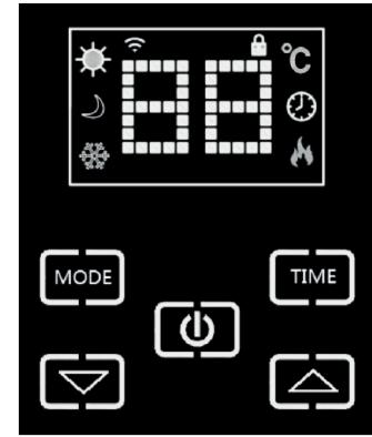
Включите питание обогревателя при помощи переключателя на боковой панели устройства. При включении обогреватель издаст звуковой сигнал и войдёт в режим ожидания, отображая значок Wi-Fi и текущую температуру в помещении.
