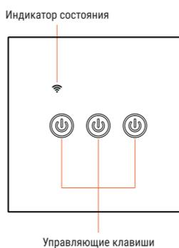
Количество и вид управляющих клавиш зависят от используемой модели выключателя
