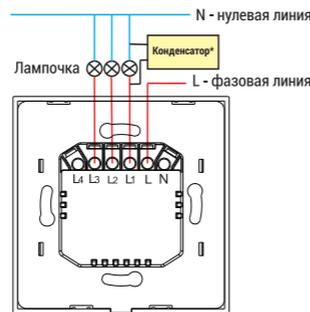
\*При подключении устройства используйте конденсатор, входящий в комплект поставки.
